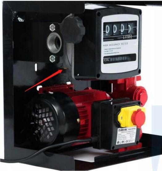
Wenn der Zähler die gepumpte Flüssigkeitsmenge nicht korrekt anzeigt, bereiten Sie eine genau abgemessene Menge von 30 Litern Kraftstoff vor. Stellen Sie den Zähler mit Hilfe der Nadel am Zähler zurück. Bevor Sie mit der Kalibrierung beginnen, entlüften Sie das System nach der Flüssigkeitszufuhr, bis ein voller und gleichmäßiger Durchfluss erreicht ist.
